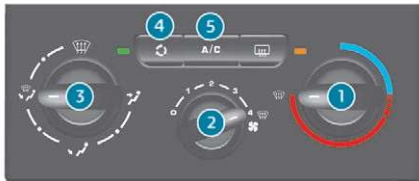
Aire acondicionado manual
