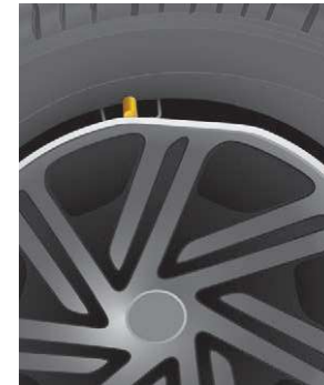
Deformación del borde del tapacubos en la válvula debido a un montaje incorrecto.
